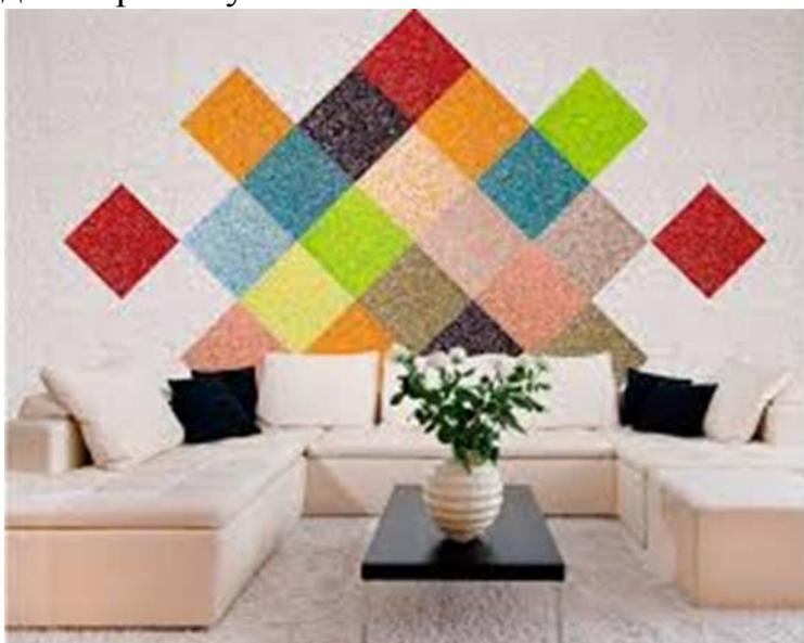
Преимуществом таких обоев является их легкая реставрация. Поврежденное место достаточно смочить теплой водой, а затем с помощью острого ножа удалить данную часть покрытия, и нанести новый слой.
