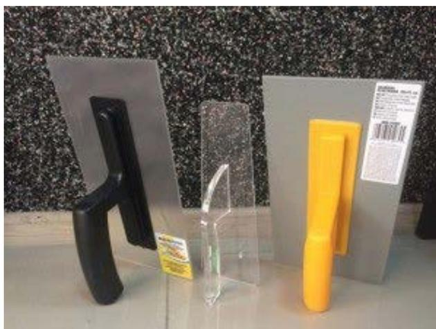
**Шпатель (8см – 10 см)** – это инструмент предназначенный для нанесения смеси на тёрку.
