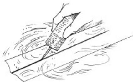
Холодную сварку швов можно произвести клеем в спец. тюбике. Вставляем наконечник в форме иглы в место шва и аккуратно проходимся вдоль всего стыка, чтобы заполнить всю глубину.
