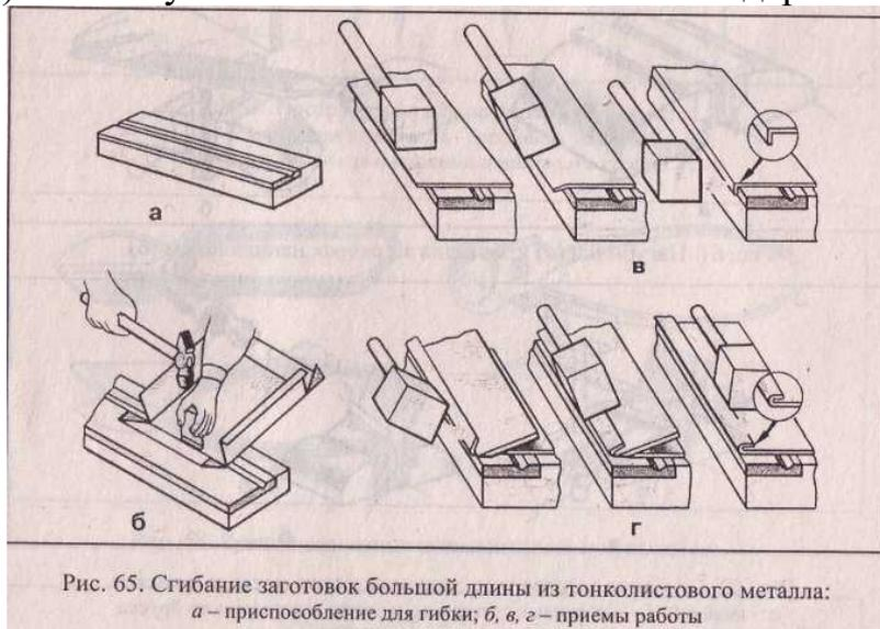
Рис. 65. Сгибание заготовок большой длины из тонколистового металла:
