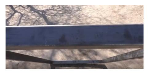
На профильной трубе размечаем ножки стола по 800мм 4 шт.
