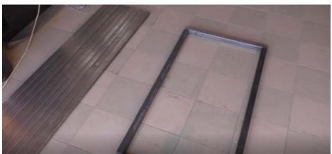
Включаем сварочный инвертор. устанавливаем силу тока 60-70 А. диаметр электрода 3мм. Делаем прихватки. Внимательно проверяем размеры.
