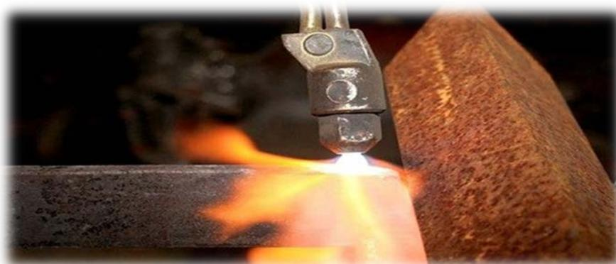
Если по расчету требуется нагревать несколько расположенных рядом клиньев, то часть б для них намечается общей **нагрев гребенкой**, что обеспечивает непрерывность процесса.
